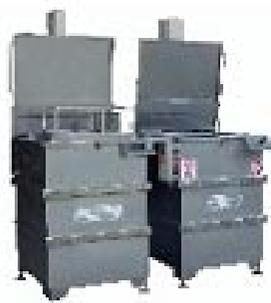
**LAVAGGIO ad IMMERSIONE** è il processo mediante il quale il liquido di lavaggio entra in contatto con tutte le superfici delle parti da lavare. Esso è preferito per applicazioni ove le parti richiedono un contatto prolungato richiesto dal tipo di contaminazione da rimuovere o dalla geometria delle parti. Il sistema AGI-DIP aumenta le prestazioni muovendo le parti all'interno del liquido.
